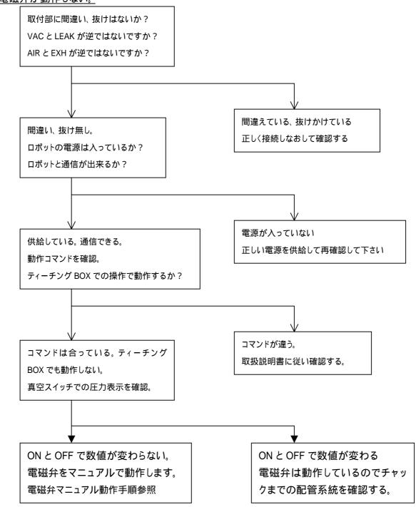
\* 真空圧(VAC) 側ではなく破壊ポート(LEAK)側に真空圧をつないだ場合、ON/OFFが逆になります。
